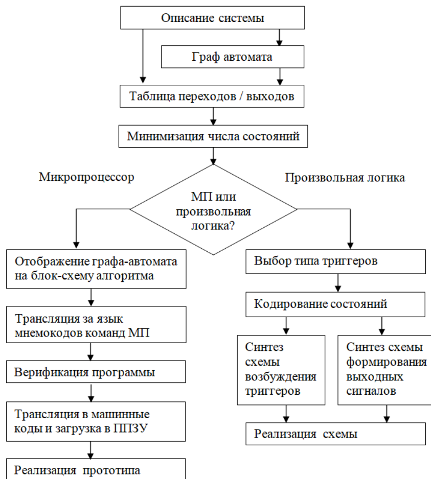
Рисунок 1. Последовательность разработки МП-системы.
