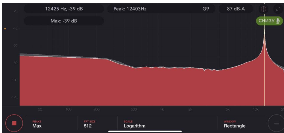
Рисунок 3. Форсунка с плохим распылом, максимальная частота 12 425 герц.
