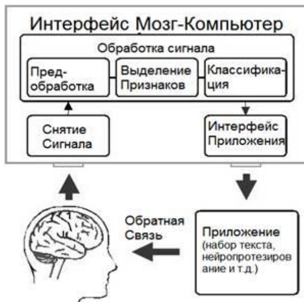
Рисунок 1. Принцип работы НКИ.
